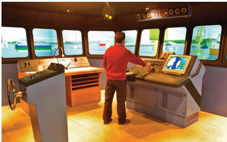
► Interior del simulador de maniobras para el acceso de buques a puertos.
