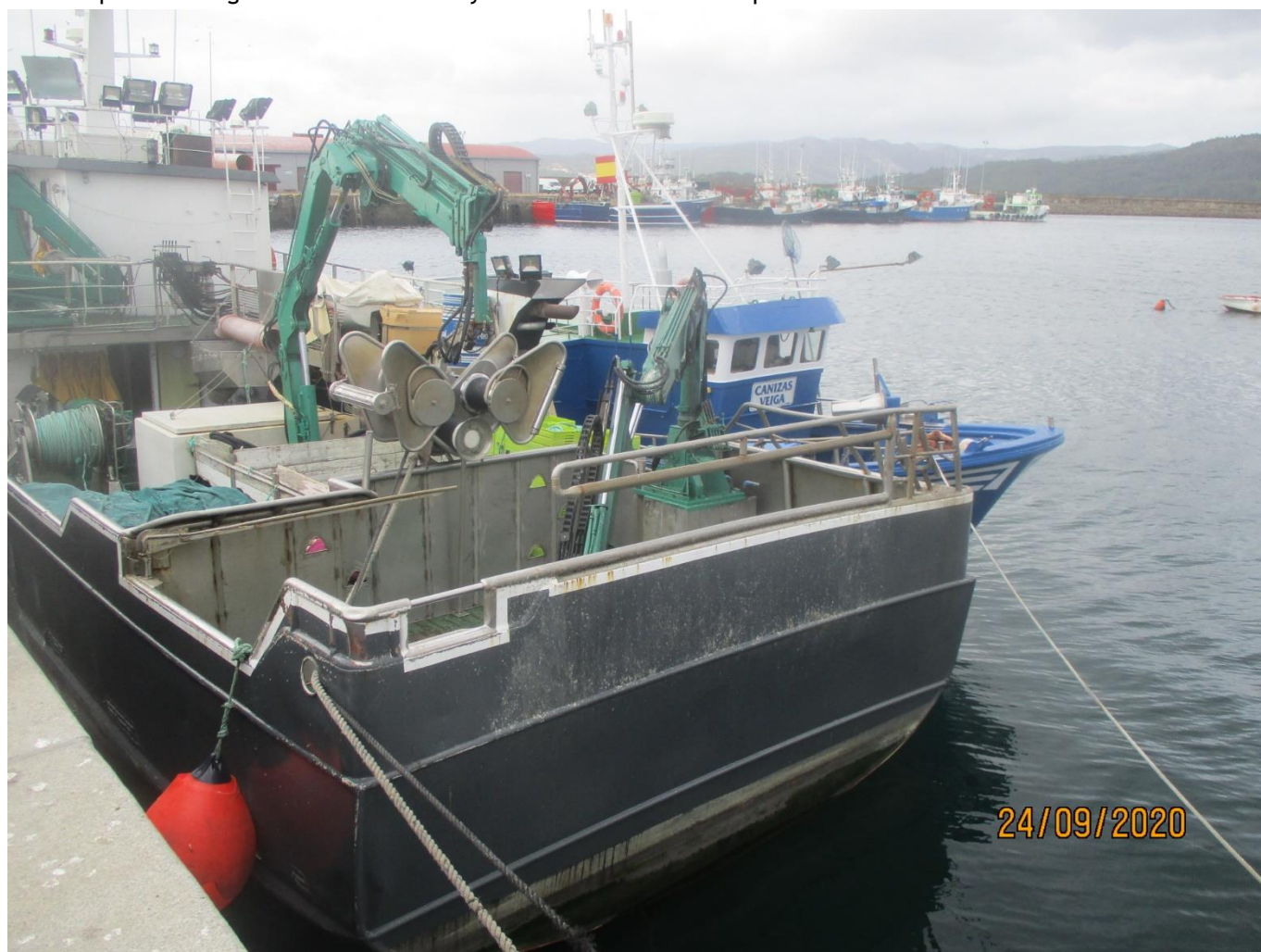
Figura 20. Tres grúas instaladas a bordo del SEMPRE GÜETO.
