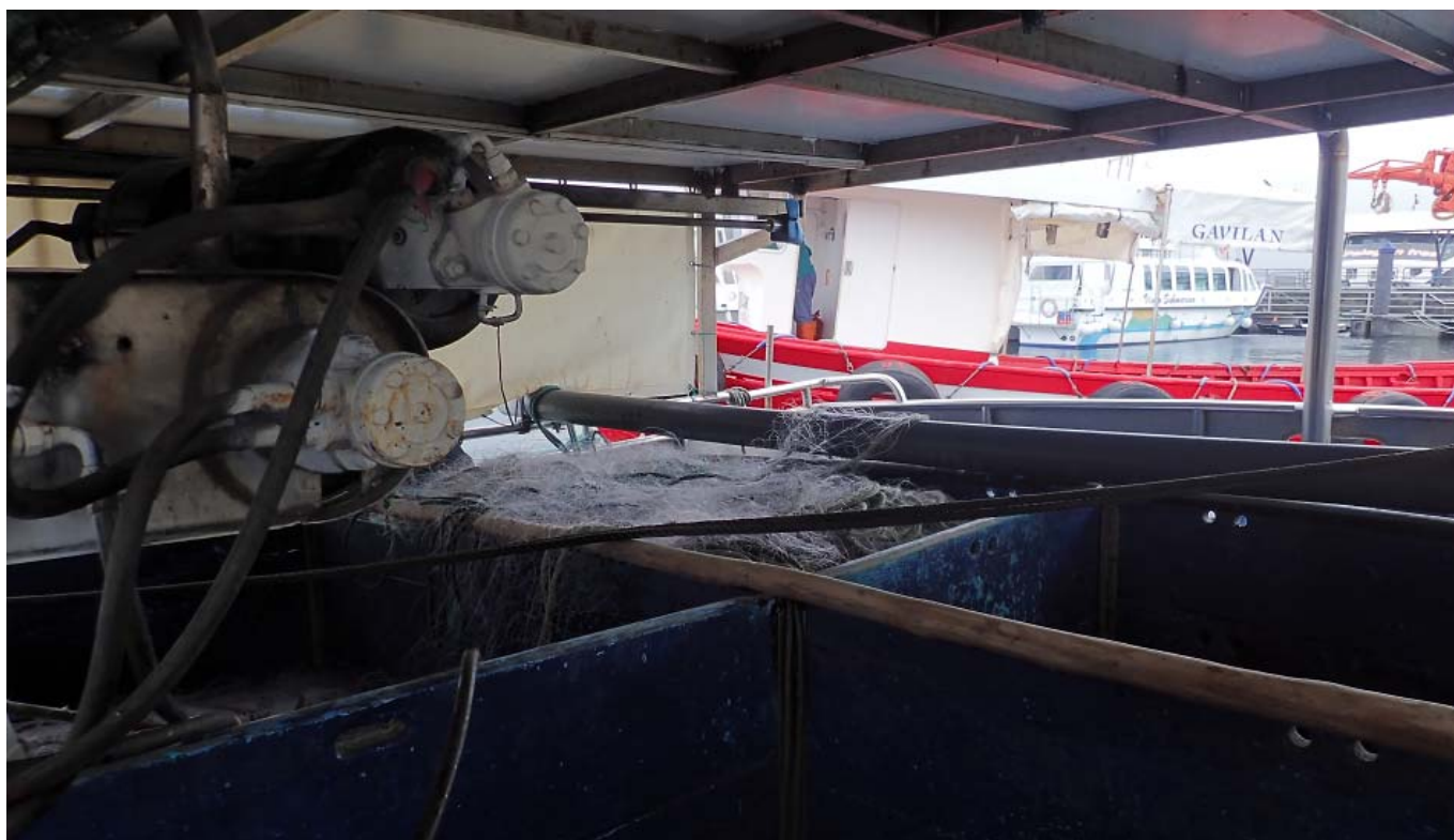
Figura 7. Encajonadas de la E/P TUCAN DOUS, tronco y tubo transversal y estibador de redes
