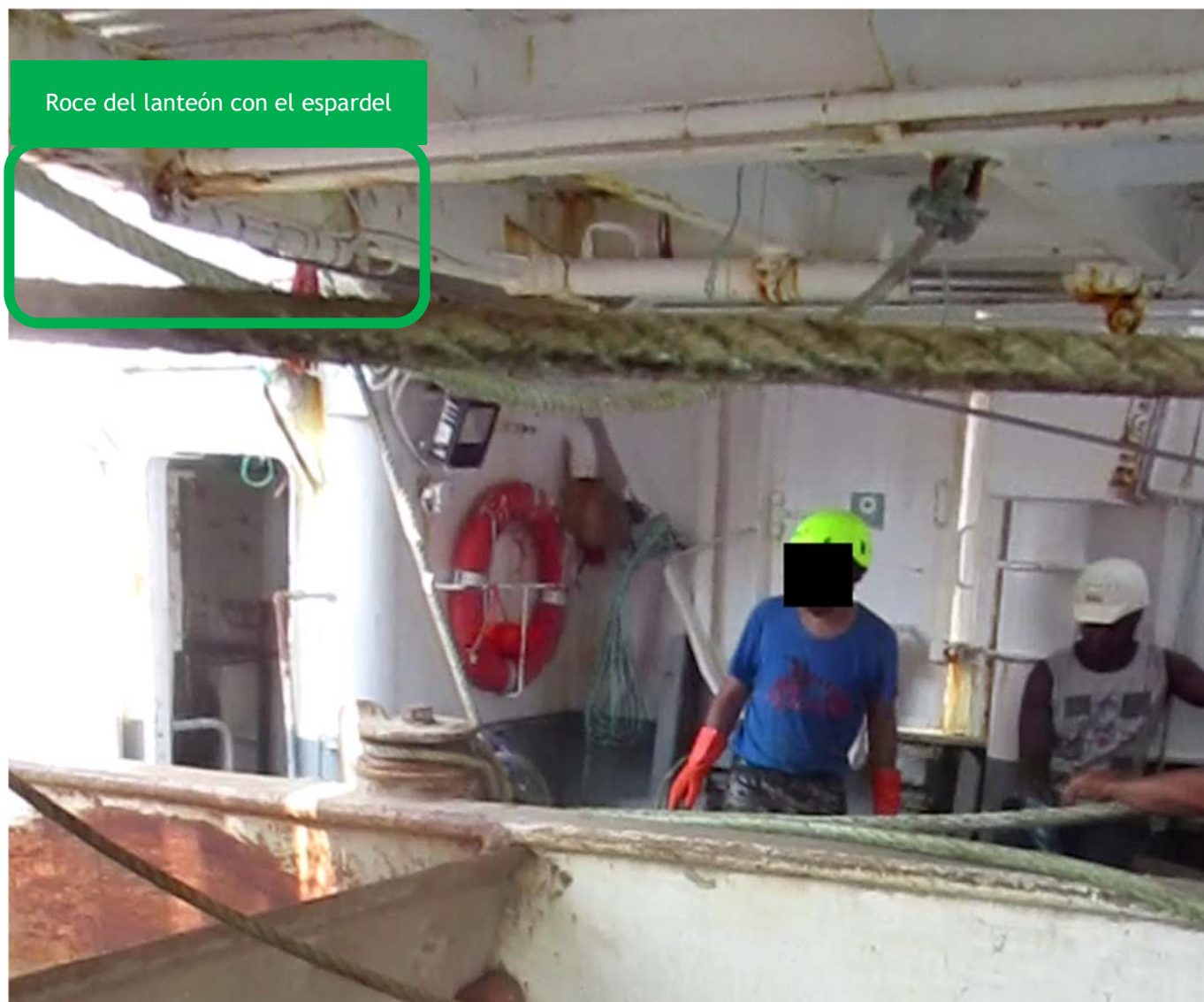
Figura 17. Roce del lanteón con el espartel, en la reconstrucción de la maniobra en Vigo
