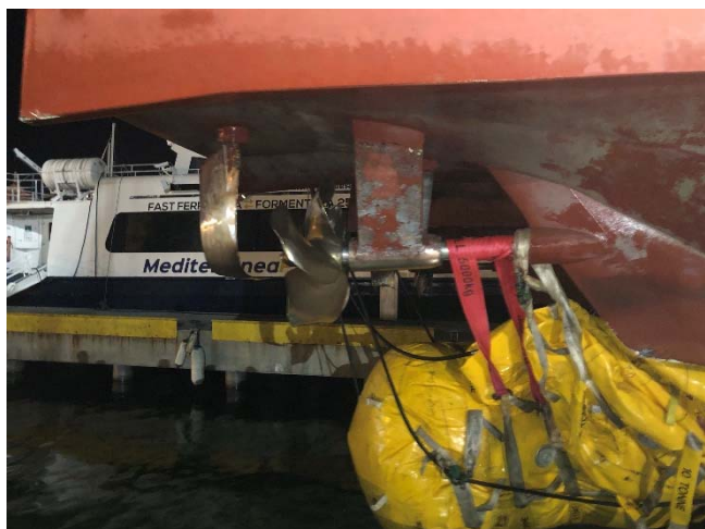
Daños sufridos por la hélice y el timón
