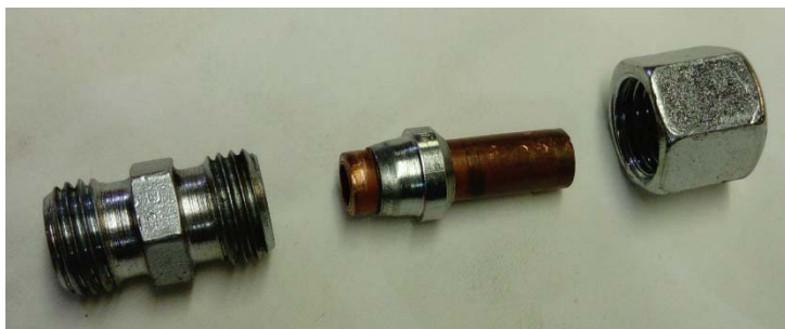
Figura 11. Sistema de montaje con ovalillo y tuerca de sujeción (nuevos).
