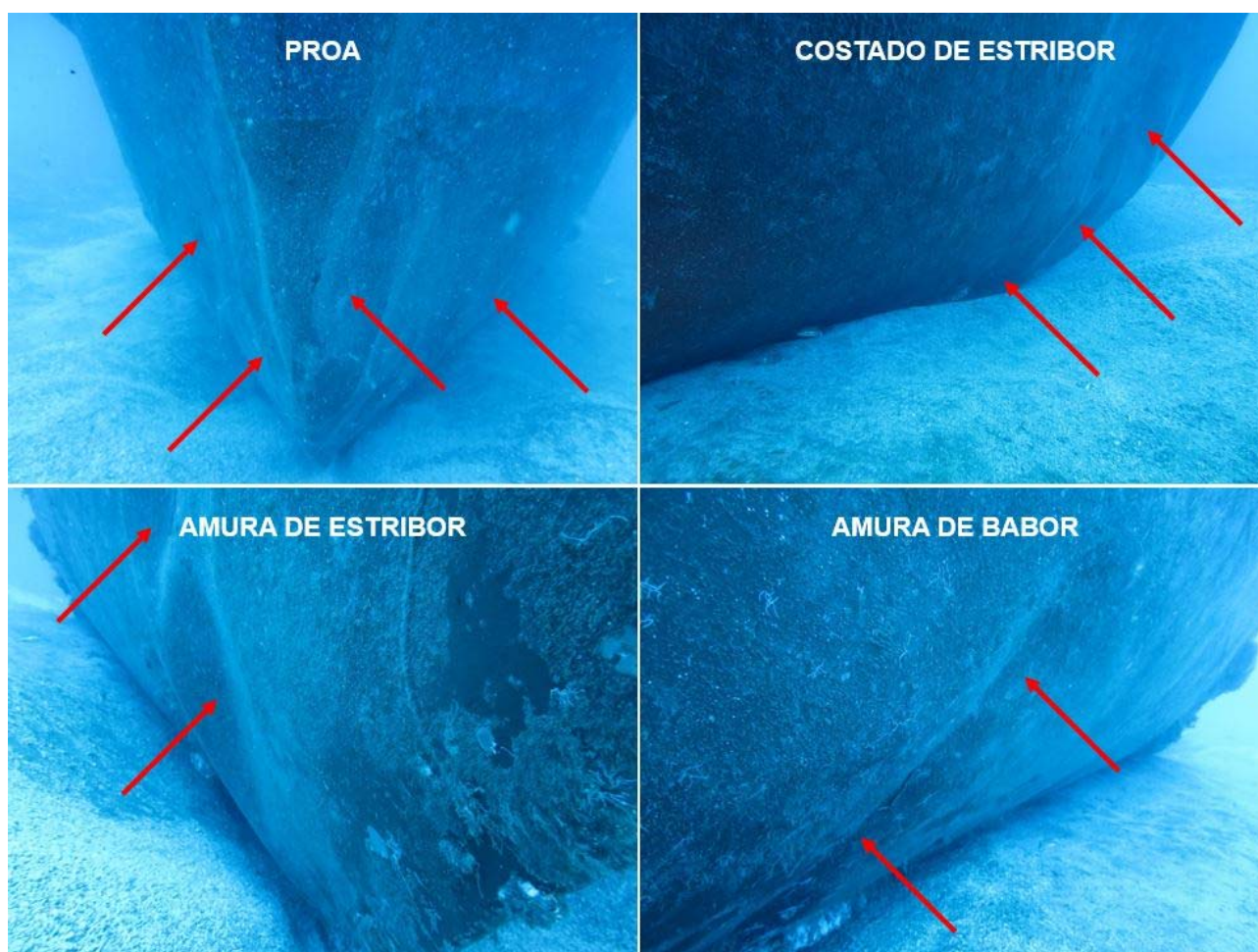
Figura 8. Daños apreciables en el forro del casco, el 29 de septiembre de 2015
