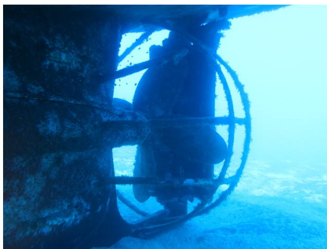
Figura 9. Estado de la hélice y el timón, el 29 de septiembre de 2015
