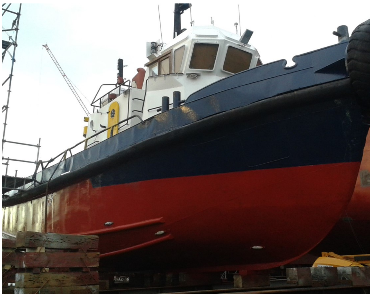
Figura 7. Estado que presentaba el casco del remolcador tras las reparaciones efectuadas durante la varada, el 26 de noviembre de 2014
