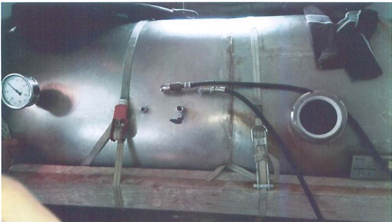
Figura 7. Válvulas de bola y conexiones de aire y oxígeno a la cámara hiperbárica
