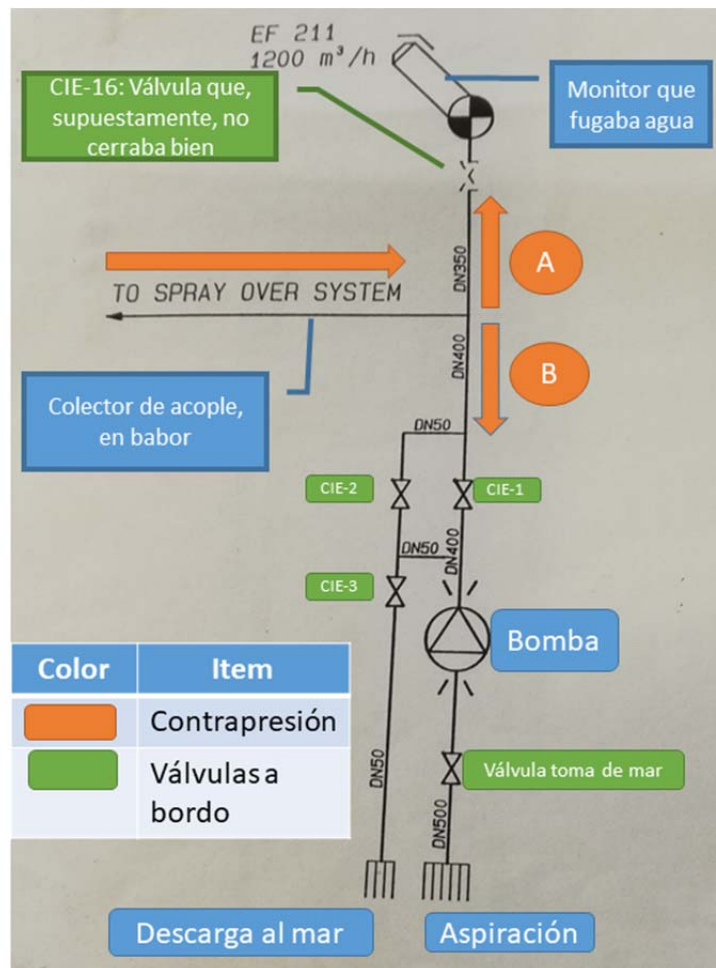
Figura 9. Disposición de elementos principales alrededor de la bomba
