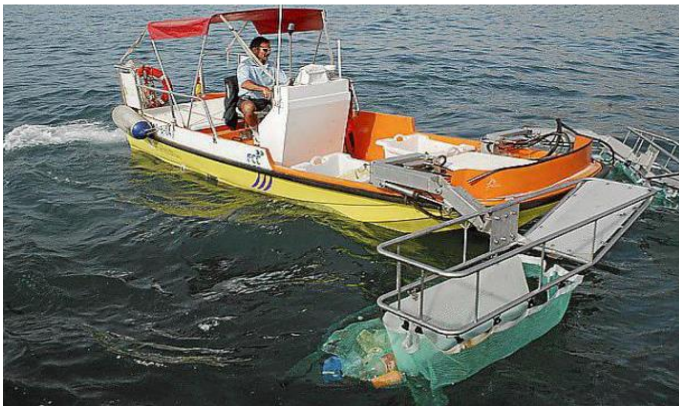
Figura 5. Embarcación similar a la ESVAT VEINTIUNO. Ver detalle de los brazos para recogida de residuos
