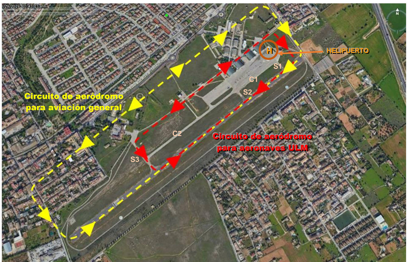
Figura 5. Circuito de aeródromo
