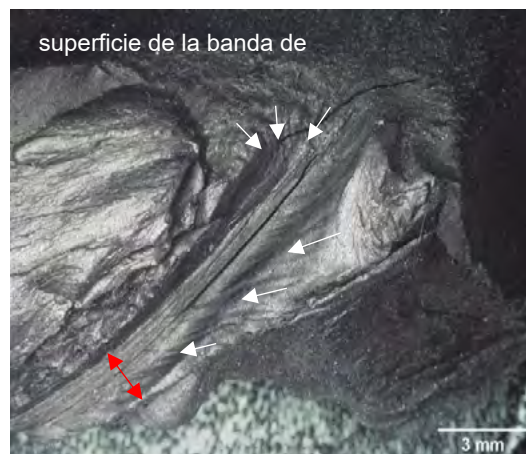
Figura 24. Deformación del material en la banda de rodadura de la pieza B
