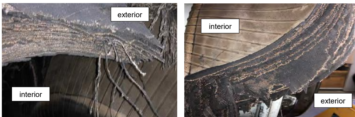
Figura 19. Roturas directas (izq) y escalonadas (der) en el cuerpo del neumático número 5
