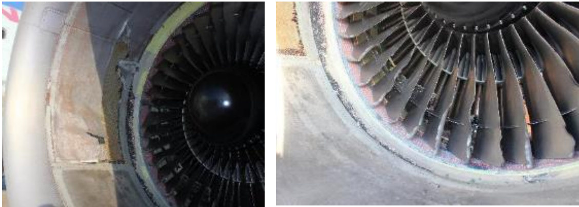
Figura 15. Daños en el fan
