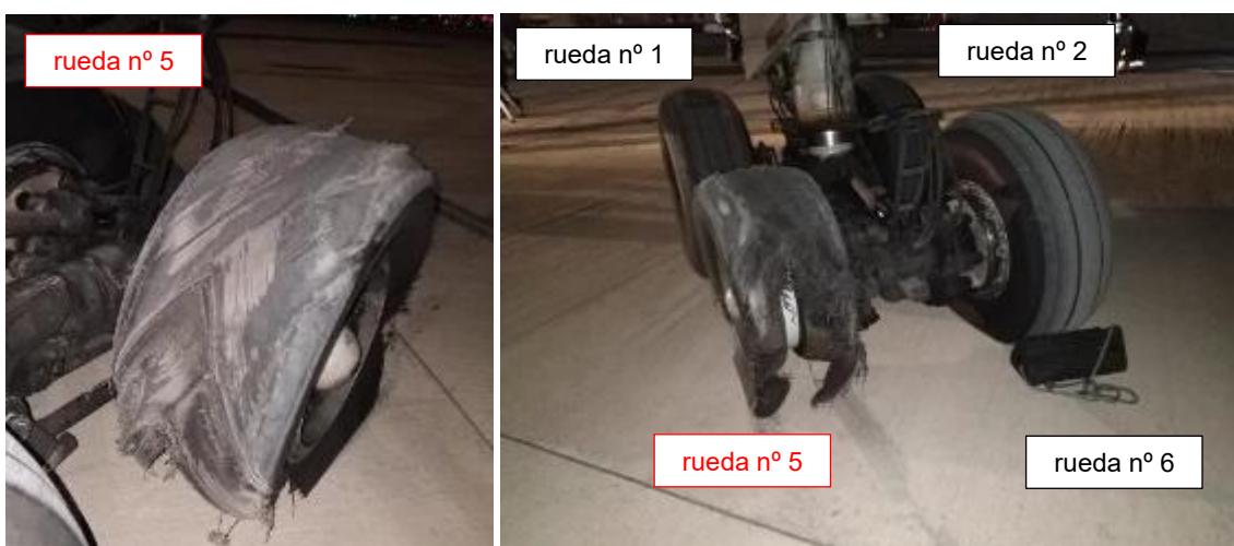
Figura 5. Tren principal izquierdo (visto desde atrás) tras el aterrizaje
