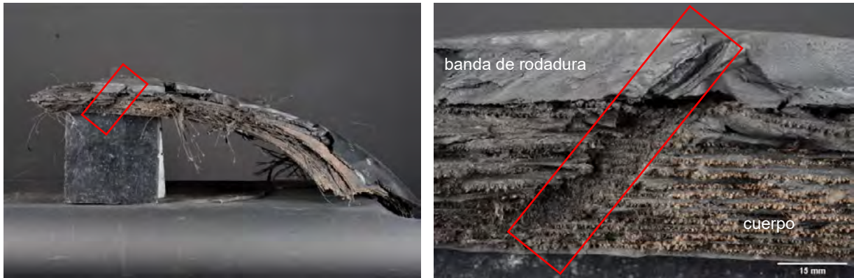
Figura 23. Perforación en la pieza B (cuerpo y banda de rodadura)
