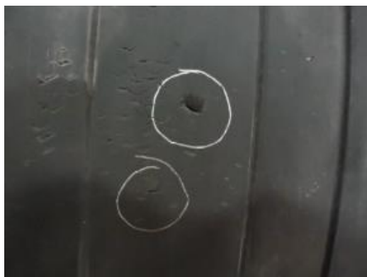
Figura 17. Cortes en la rueda número 6 (compañera de la 5) producidos el 30/01/2020
