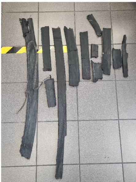
Fig. 6.- Restos recogidos de la banda de rodadura
