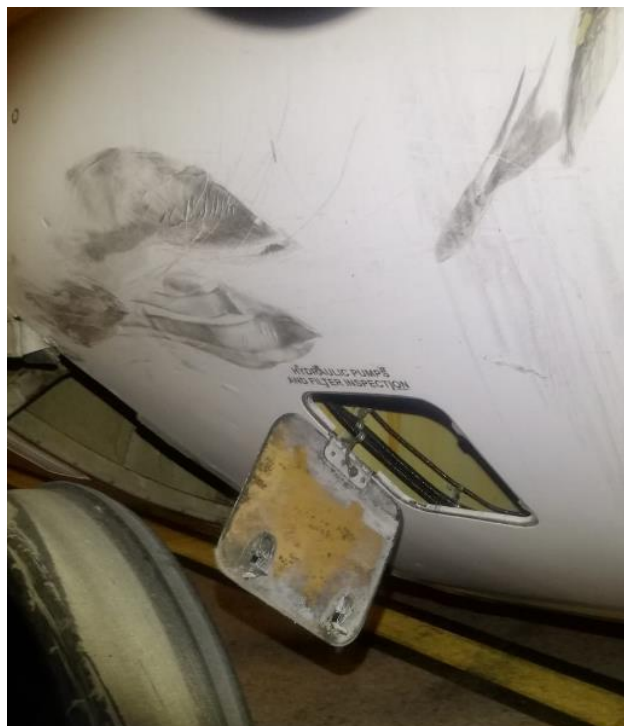
Fig.4.- Panel de inspección-registro y marcas de goma
