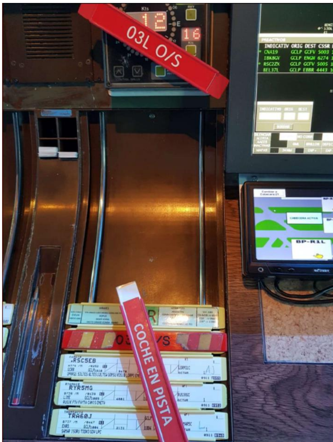
Figura 5: imagen real de la disposición de fichas en la bahía del puesto de control
