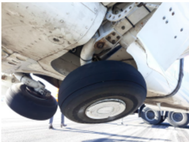
Fotografía 21. Tren de aterrizaje principal retraído de la aeronave del incidente
