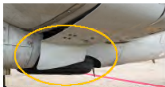
Fotografía 18: Cierre de compuerta lateral izquierda de tren principal con deformación
