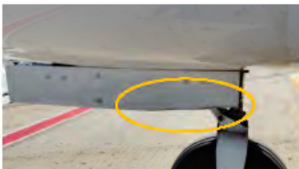
Fotografía 17: Deformación de compuerta de morro
