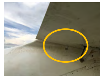
Fotografía 12: Daños en encastre del ala derecha
