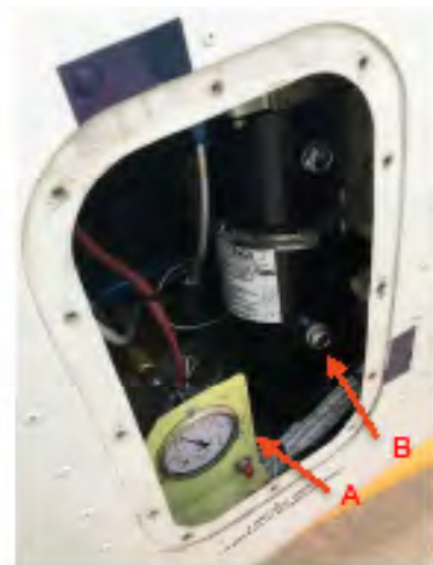
Fotografía 23. A: Botón de carga del acumulador hidráulico B: Válvula de alivio
