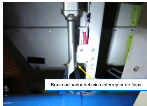
Fotografía 27: Microinterruptor del sistema de aviso del tren de posición de los flaps
