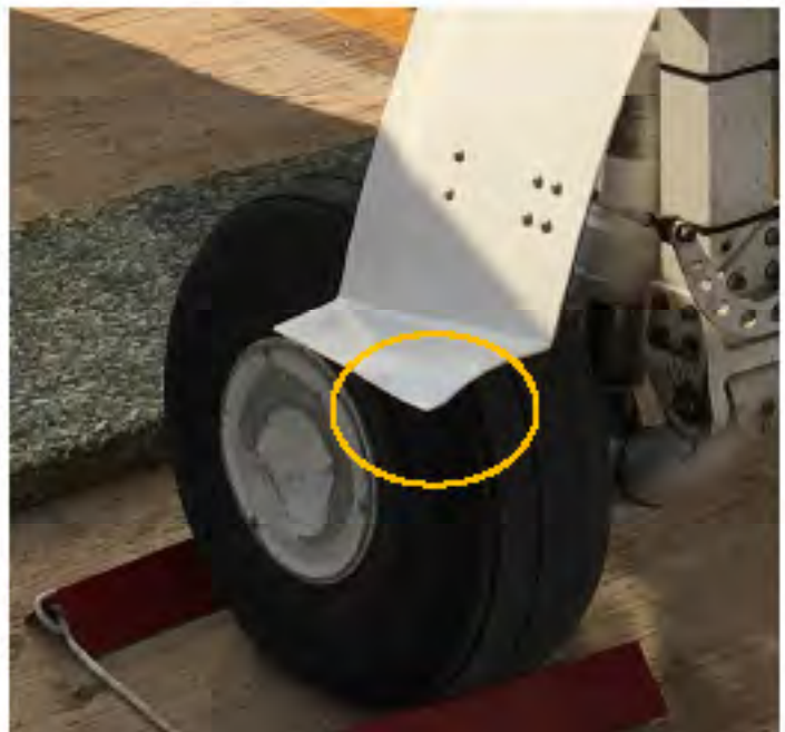
Fotografía 16: Deformación de compuerta lateral de pata derecha
