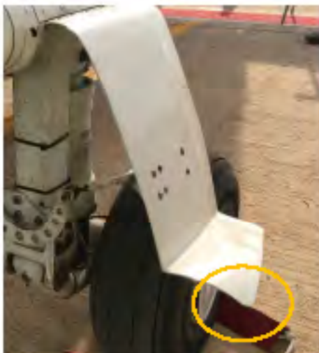
Fotografía 15: Deformación de compuerta lateral de pata izquierda
