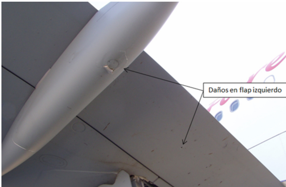
Figura 8. Daños en flap y carenado
