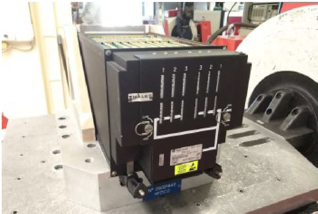
Figura 13. BSCU en banco de vibraciones
