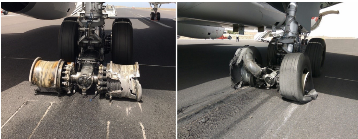
Figura 5. Estado del tren de aterrizaje principal tras el incidente
