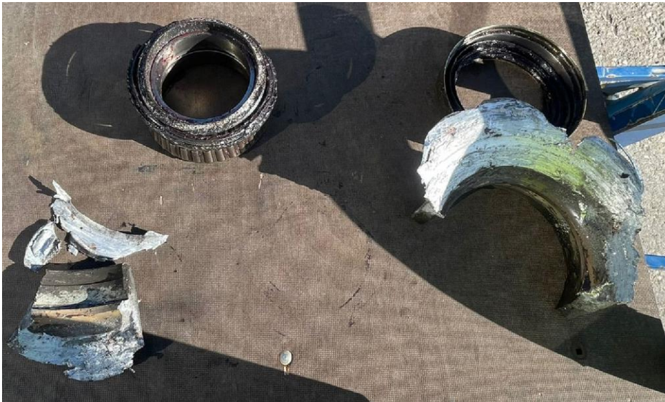
Figura 6 – Roturas asociadas a la rueda afectada.
