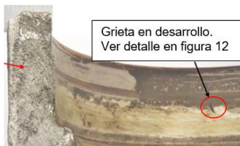
Figura 10 – Detalle superficie de rotura del buje de la semillanta interna (1).
