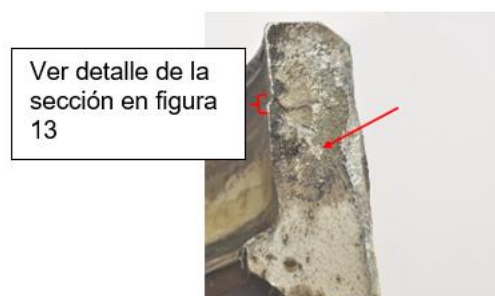
Figura 11 – Detalle superficie de rotura del buje de la semillanta interna (2).
