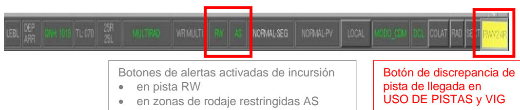
Figura 6. VIG de la posición 2 de la torre este
