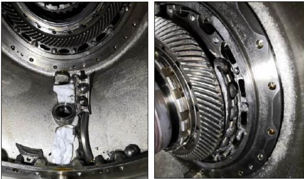
Figs. 19 y 20: Estado y restos del rodamiento número 3 in situ
