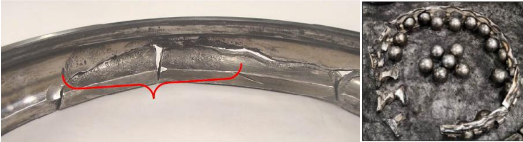
Figs. 17 y 18: Estado y restos de la jaula y la pista del aro exterior del rodamiento 3
