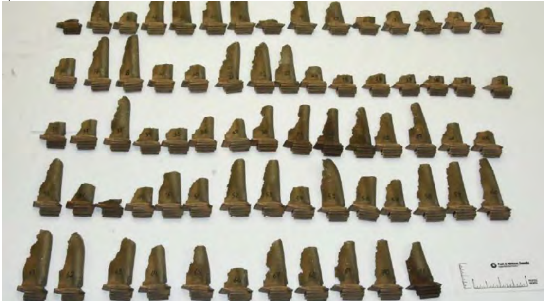
Figura 9. Restos de los álabes encontrados
