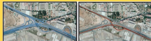
A la izquierda, en azul, tramos de carretera disponibles en IGR-RT para una zona determinada; a la derecha, en rojo, generalización para Hermes.
