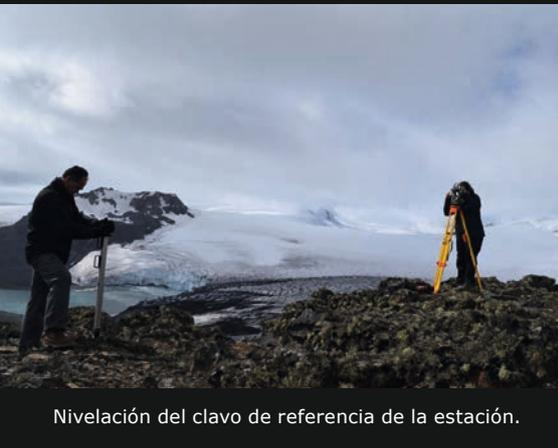
Nivelación del clavo de referencia de la estación.
