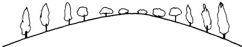
Fig. 4. Plantación en cambio de rasante (Alzado)
