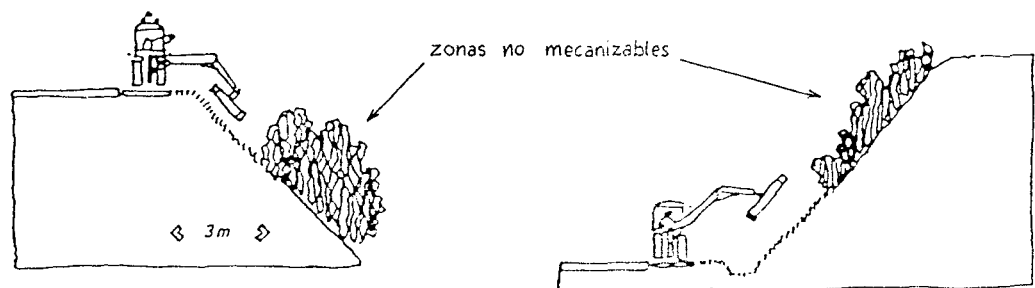
Fig. 45. Mantenimiento de las zonas superior e inferior de grandes taludes
