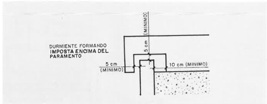
Fig. 8.7. UNION DEL DURMIENTE CON EL PARAMENTO
