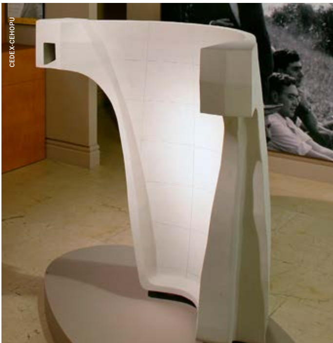
Modelo de ensayo de la presa de Quesada (Granada) del ingeniero Carlos Fernández Casado. Escala: 1:50. Archivo Carlos Fernández Casado.
