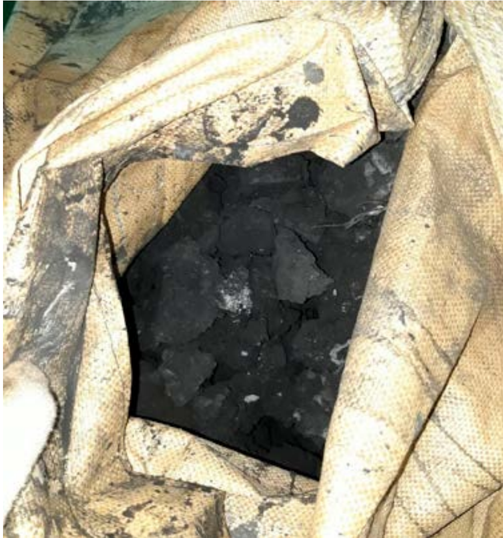
Residuos de combustible procedentes de un scrubber de circuito cerrado.
