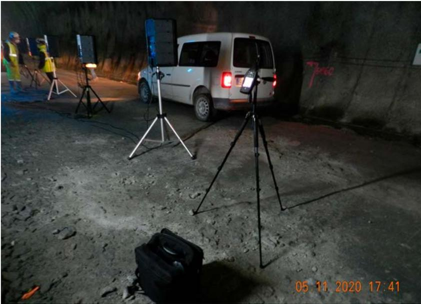
Ensayo de emisión/inmisión de ruido, con ruido generado desde el interior del túnel.
