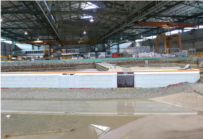
Ensayo presiones sobre el espaldón en el CEPYC .
