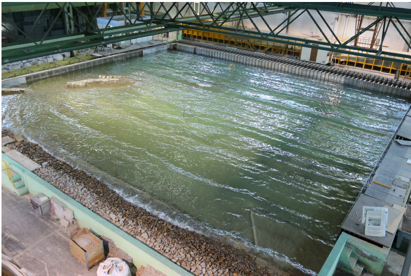
Ensayos de oleaje en el CEPYC.
