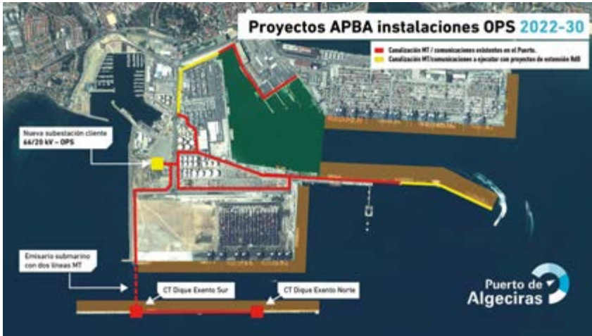
Conexión a la red eléctrica de distribución para OPS Puerto de Algeciras: Zona 4. Fuente: Autoridad Portuaria de la Bahía de Algeciras.
