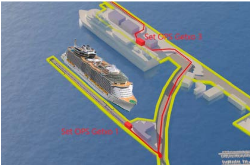
4ª acometida con cable subacuático y 2 SET OPS, canalización y tomas para cruceros. Fuente: Autoridad Portuaria de Bilbao.
