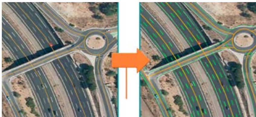
Obtención de las marcas viales a partir de técnicas de Inteligencia Artificial.
