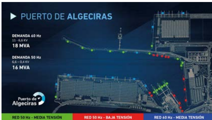
Previsión distribución de tomas (ISDEFE-2014). Fuente: Autoridad Portuaria de la Bahía de Algeciras.
