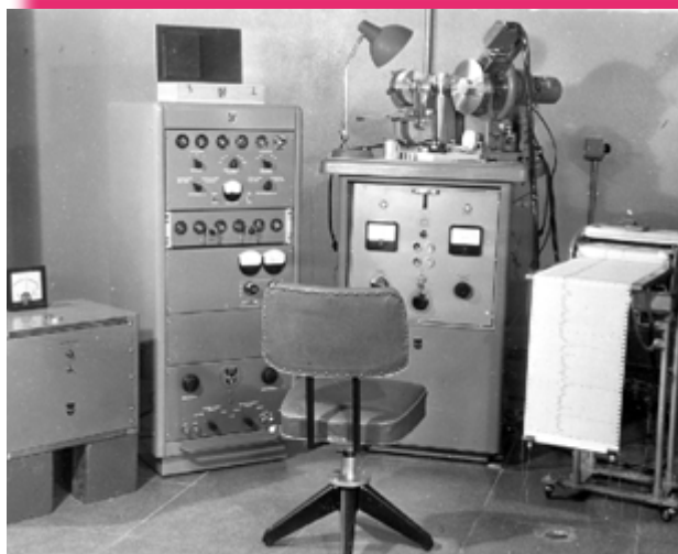
Difractor de rayos X (años 60) y microscopio electrónico de barrido (años 80).
