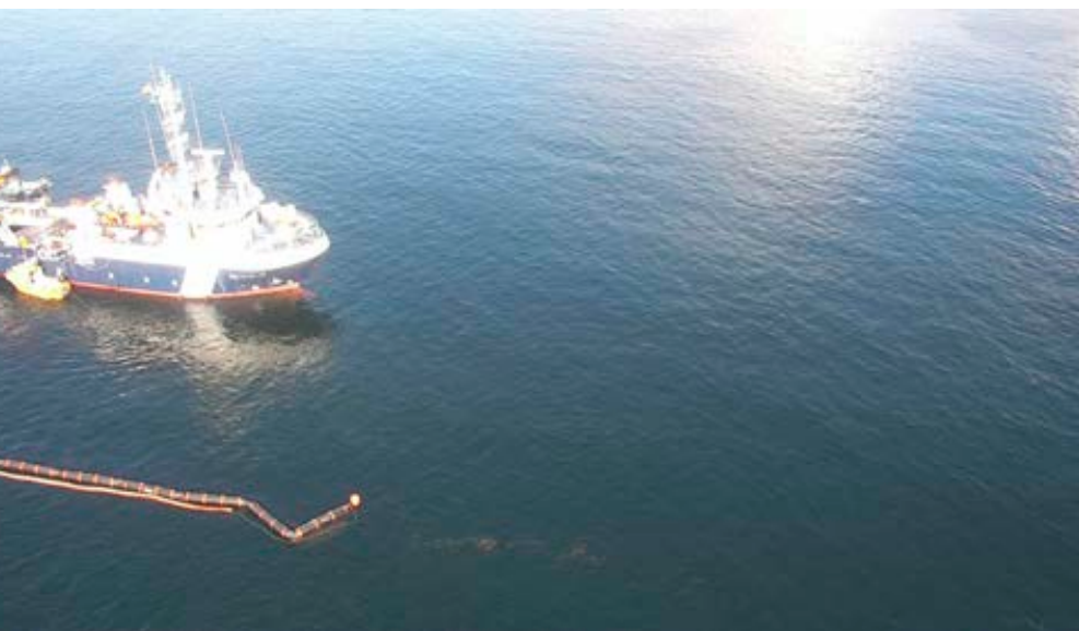
Barreras instaladas para mitigar un vertido, procedente de tierra, en la ría de Arousa, en el mes de febrero de 2020
