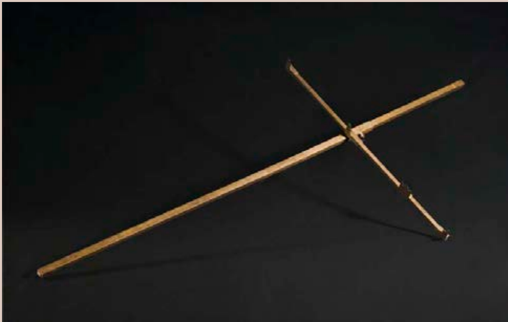
Ballestilla del s. XVI utilizada para mediciones astronómicas. Museo Nacional de Ciencia y Tecnología.
