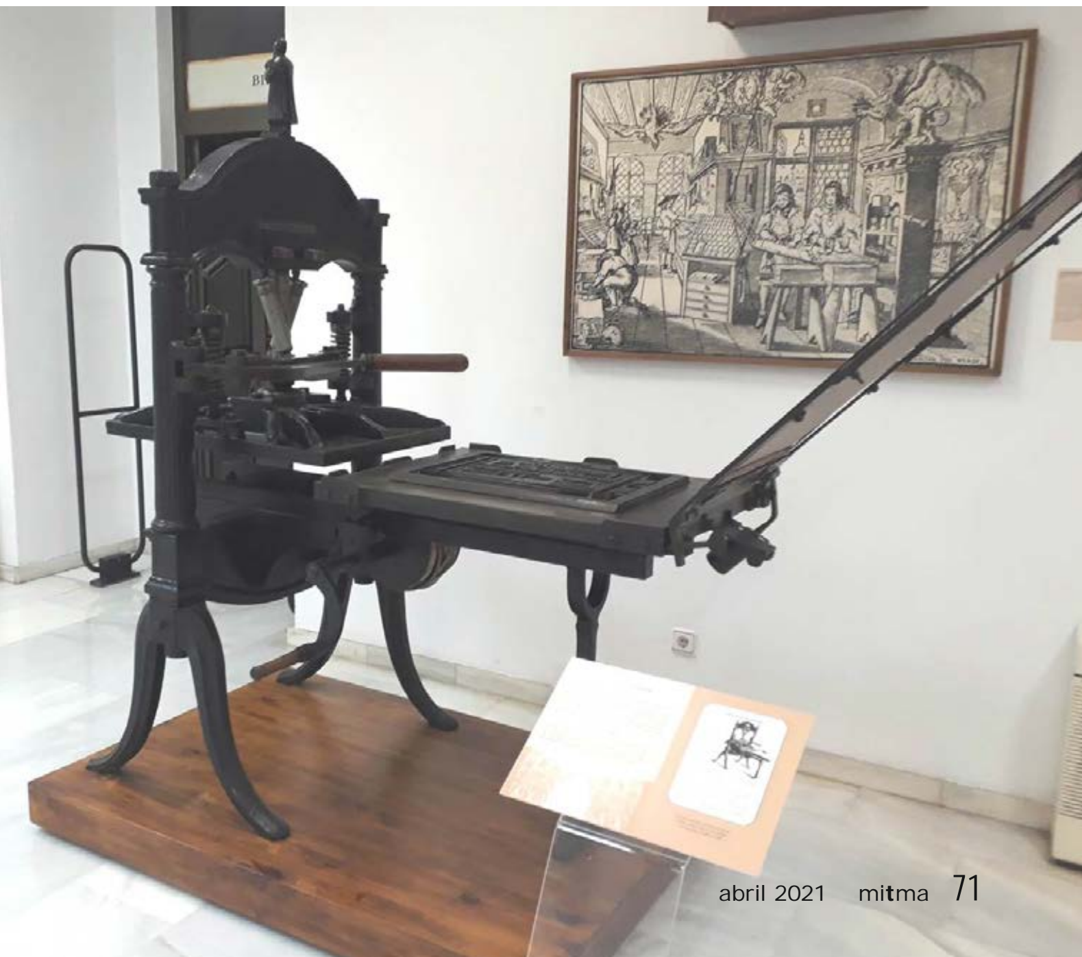
Figura 2. Prensa tipográfica ca. 1881 en exposición permanente en el Instituto Geográfico Nacional. El principio técnico de impresión de esta prensa es, con ligeras modificaciones, el mismo que Gutenberg introdujo cuatro siglos antes de su fabricación.
