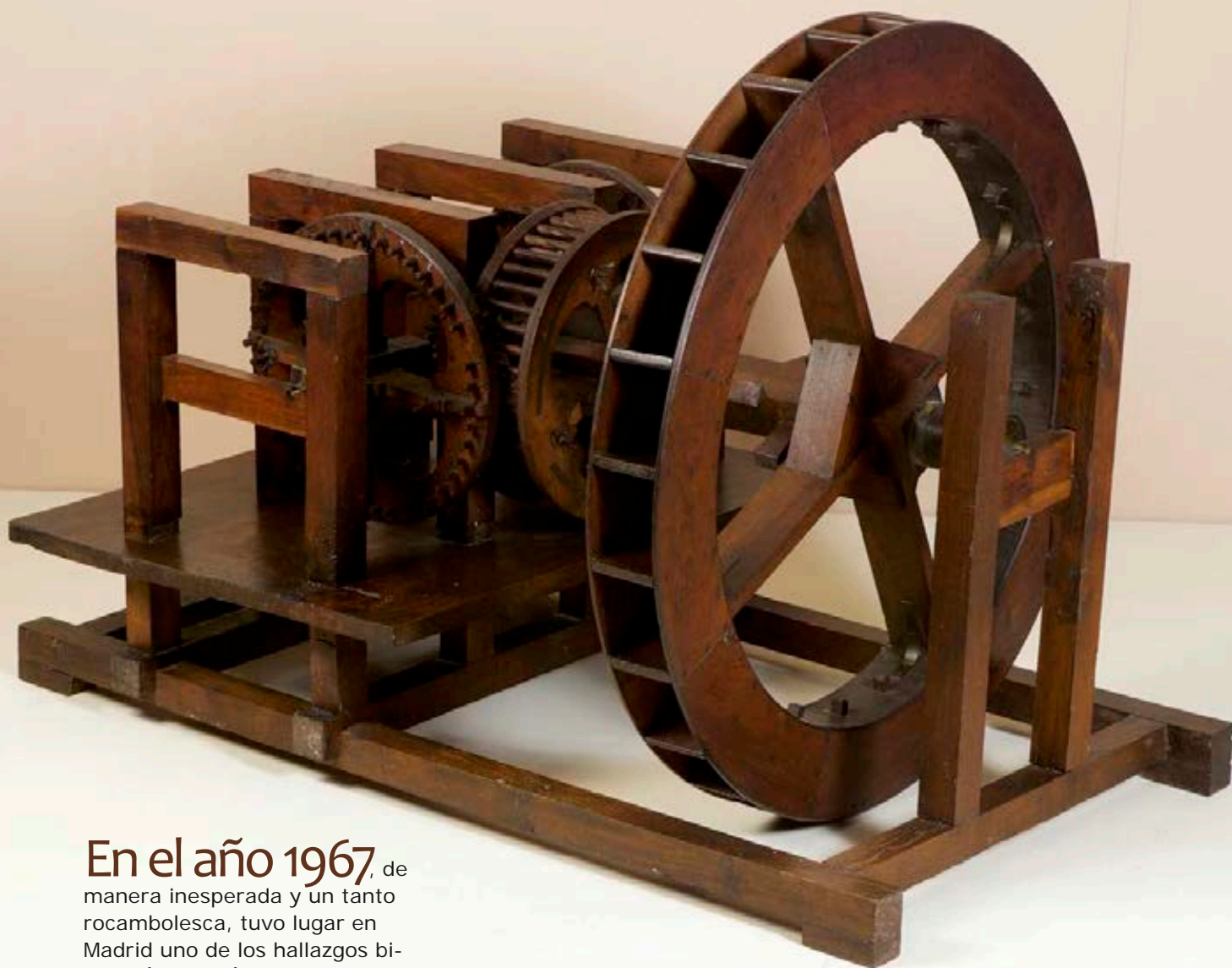
Modelo a escala de máquina para laminar y acuñar moneda. Museo de la Real Casa de la Moneda de Segovia.
