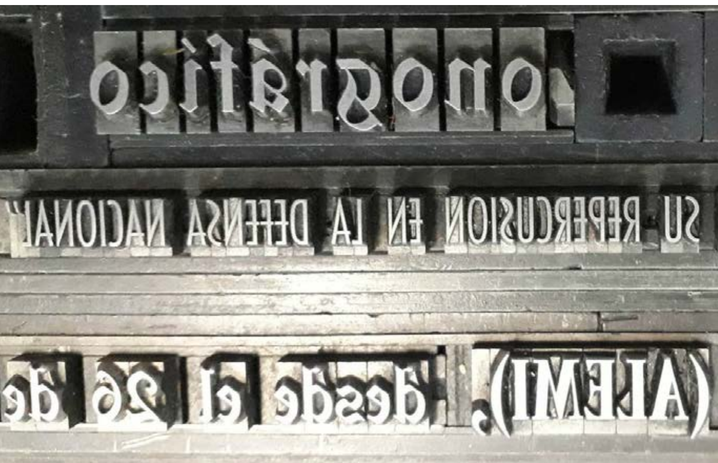
Figura 1. Detalle de una composición con tipos móviles metálicos, donde se pueden apreciar las piezas individuales colocadas para formar el texto invertido. Imagen: Instituto Geográfico Nacional.
