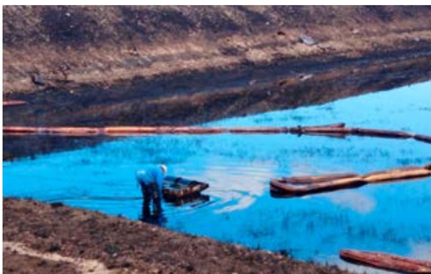
Recogida con skimmers del combustible derramado al paso del huracán Dorian en Bahamas.
