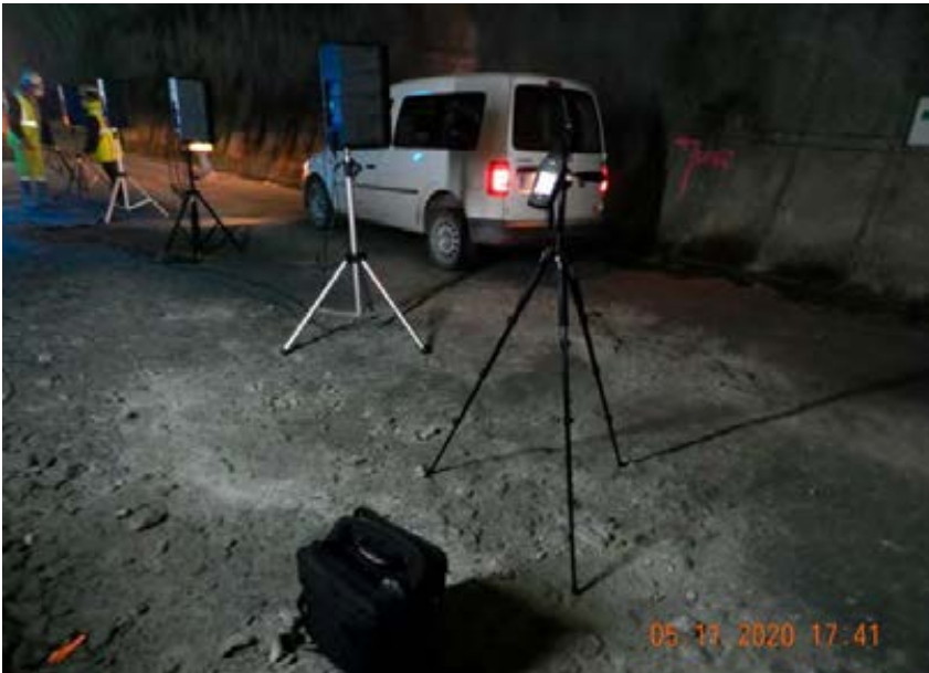
Ensayo de emisión/inmisión de ruido, con ruido generado desde el interior del túnel.
