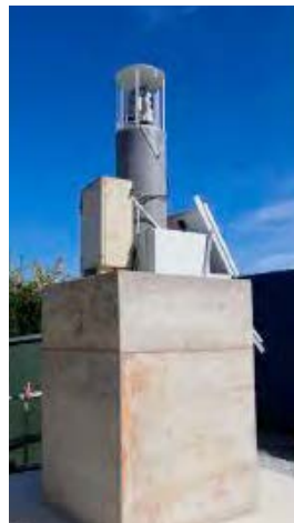
Estación total robotizada instalada en el emboquille de A Graña.
