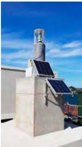
Estación total robotizada instalada en el emboquille de A Graña.
