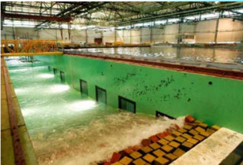
Canal de gran oleaje y viento del Centro de Estudios de Puertos y Costas.
