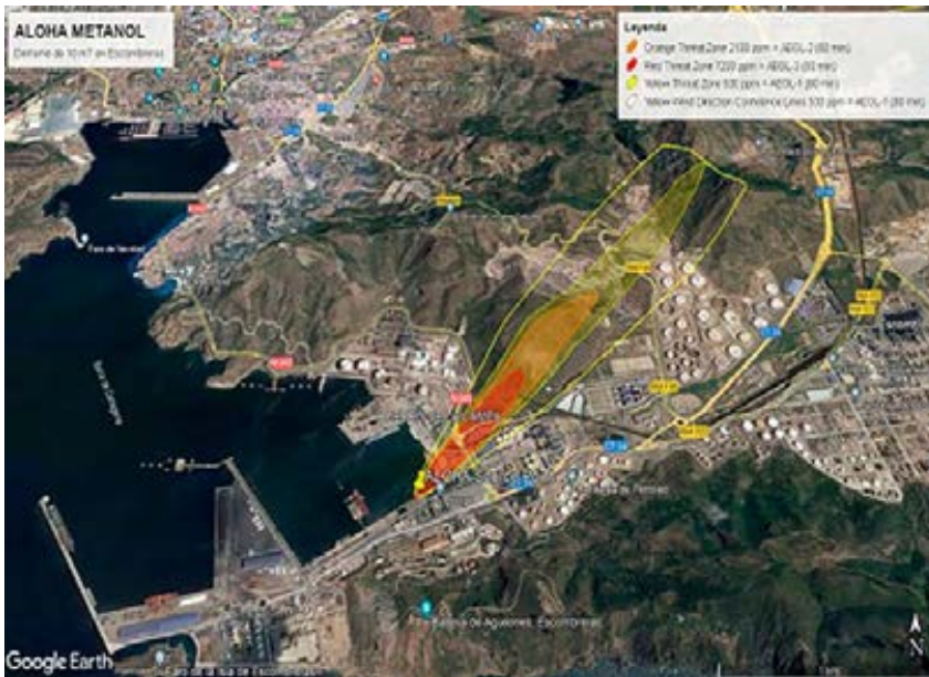
Evolución de la nube de metanol tras la fuga y áreas críticas - Programa ALOHA.
