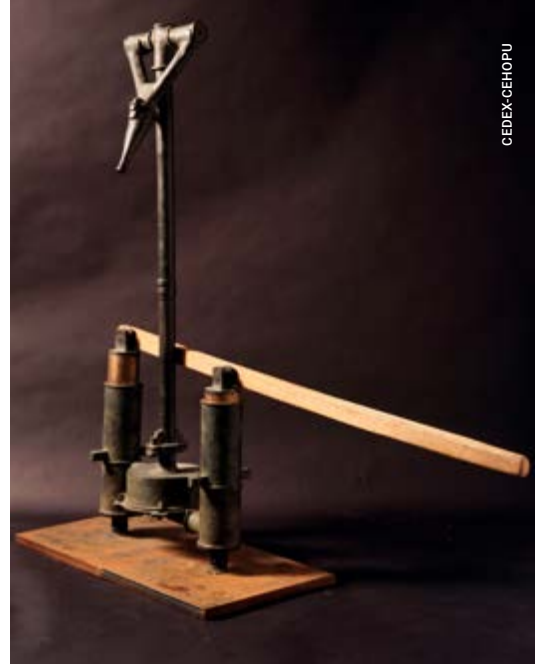
Maqueta de una bomba de Ctesibio, instrumento de la época romana que se utilizaba en trabajos de minería. (Medidas: 103 x 100 x 30 cm).
