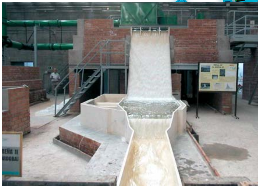
Modelo físico de una presa a escala reducida.
