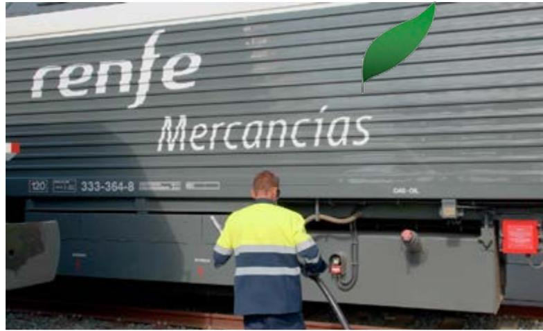
Un operador reposta diésel renovable en el depósito de la locomotora.
