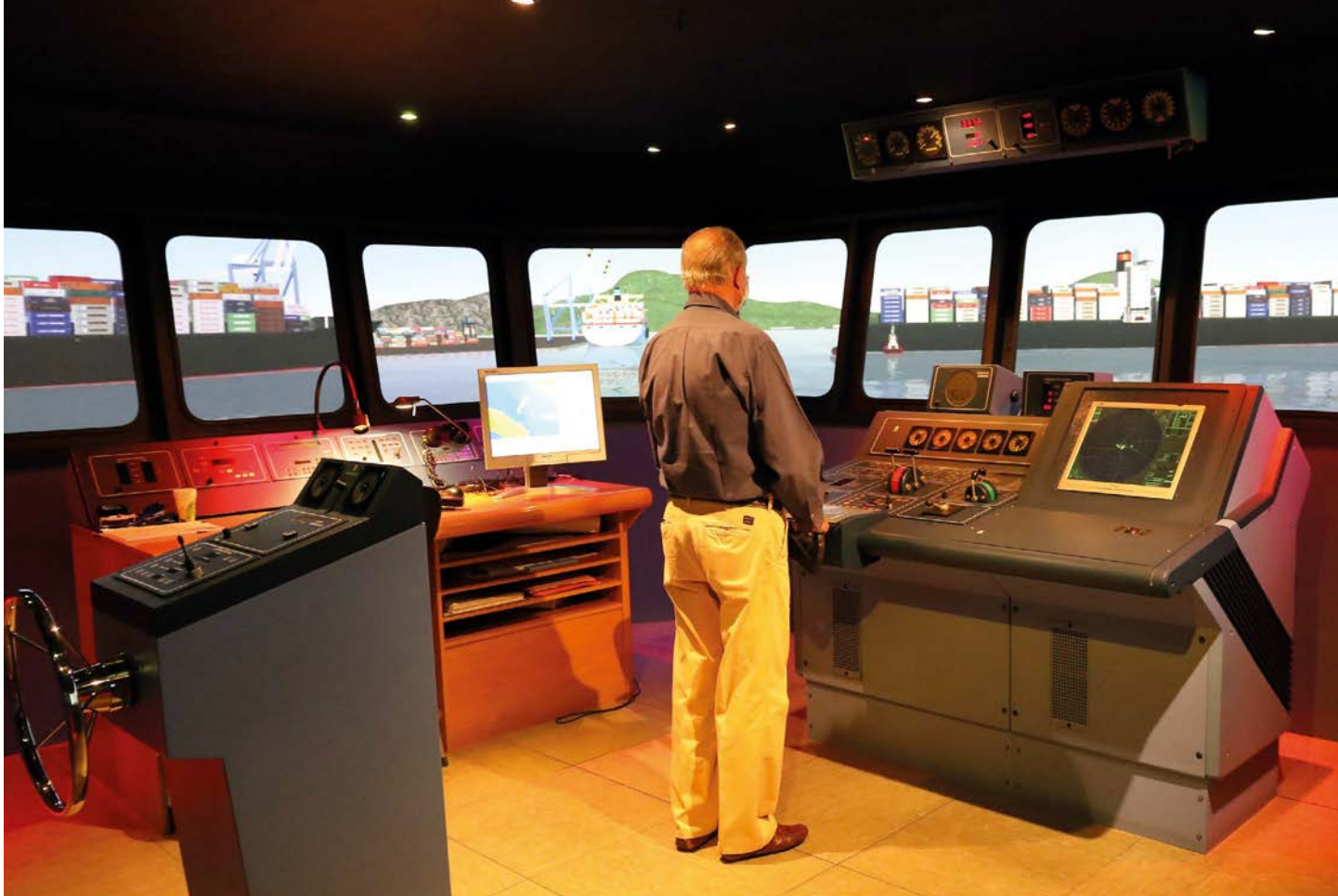
Puente principal del Simulador de Maniobra de Buques.
