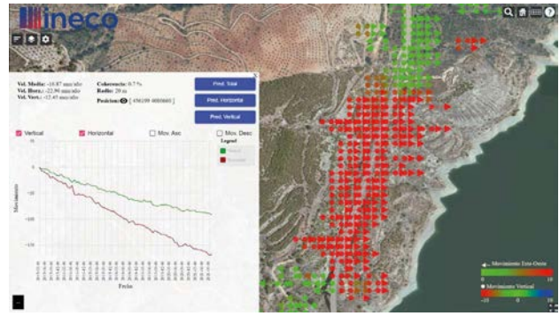
Desplazamiento de la ladera oeste del embalse de Rules. Las flechas representan el desplazamiento en la dirección E-O, y los puntos el movimiento vertical. Fuente: InecoSAR
