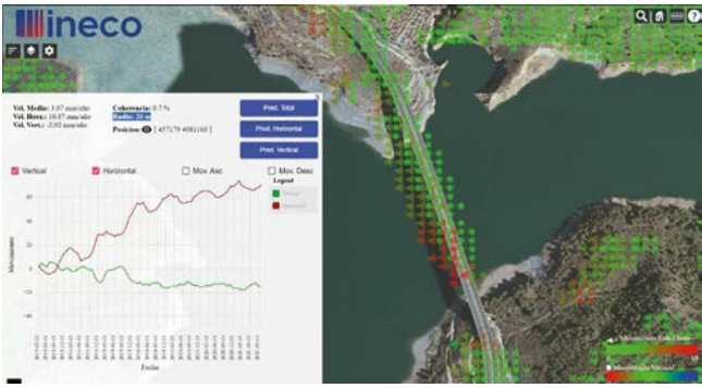
Desplazamiento de la zona próxima al estribo sur del del viaducto sobre el embalse de Rules. Las flechas representan el desplazamiento en la dirección E-O, y los puntos el movimiento vertical. Fuente: InecoSAR
