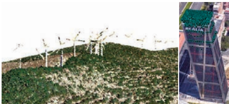
► Nube de puntos LiDAR identificando aerogeneradores.
