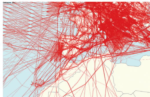
Figura 1: Rutas voladas por las aeronaves civiles, mostrando las áreas vacías, coincidentes con el espacio aéreo militar segregado.
