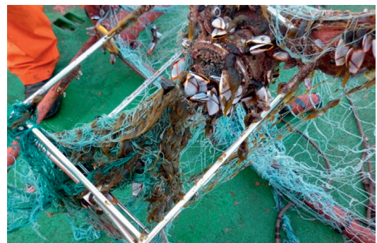
Contaminación biológica en las boyas, maniobra de mantenimiento en la posición de cabo de Gata y redes de pesca en los sensores oceanográficos.
