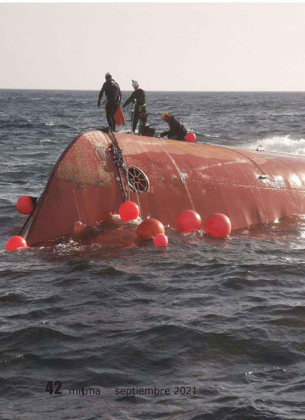
era viable y se decantaron por esta opción, introdujeron en ese túnel un tramo de cadena, que a su vez iba unido a un cable de 30 mm, en cuyo seno se metió el grillete de remolque que conectaba con el cabo de dynema del Don Inda, de 190 metros de longitud, más 500 metros de cabo principal de remolque.
