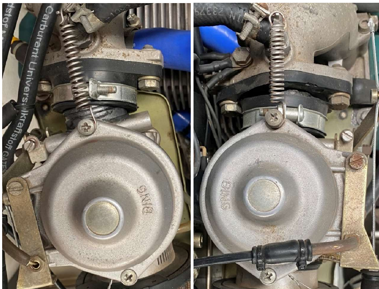
Figura 7. Condición de la instalación del carburador izquierdo (izquierda) y del carburador derecho tras el evento.
