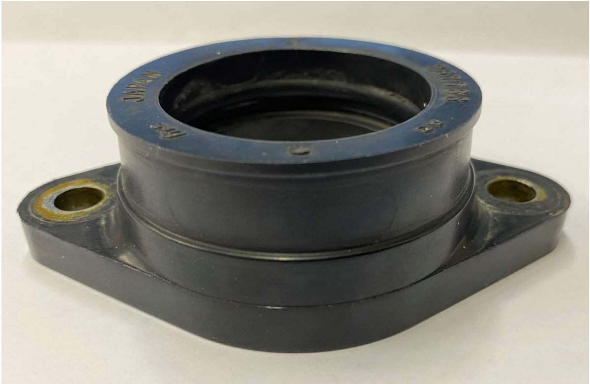
Figura 2. Instalación del conjunto del manguito del carburador según el IPC del modelo del motor de la aeronave (arriba); partes que componen el conjunto (medio); detalle del manguito del carburador (abajo).
