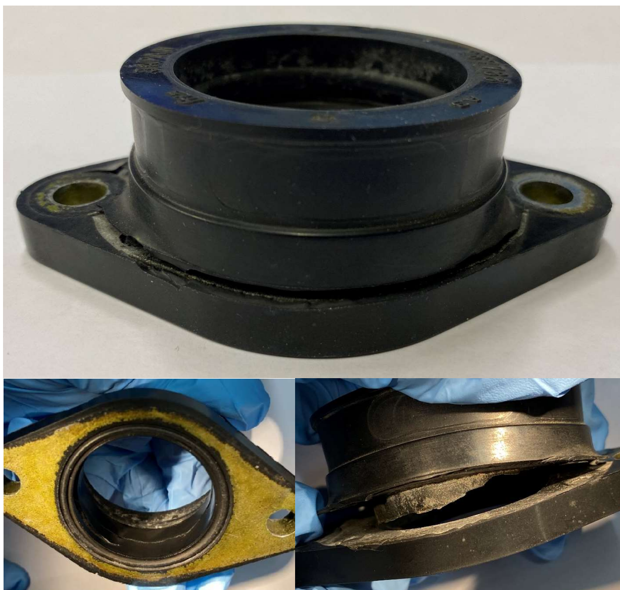
Figura 9. Detalle de la rotura del manguito del carburador derecho.
