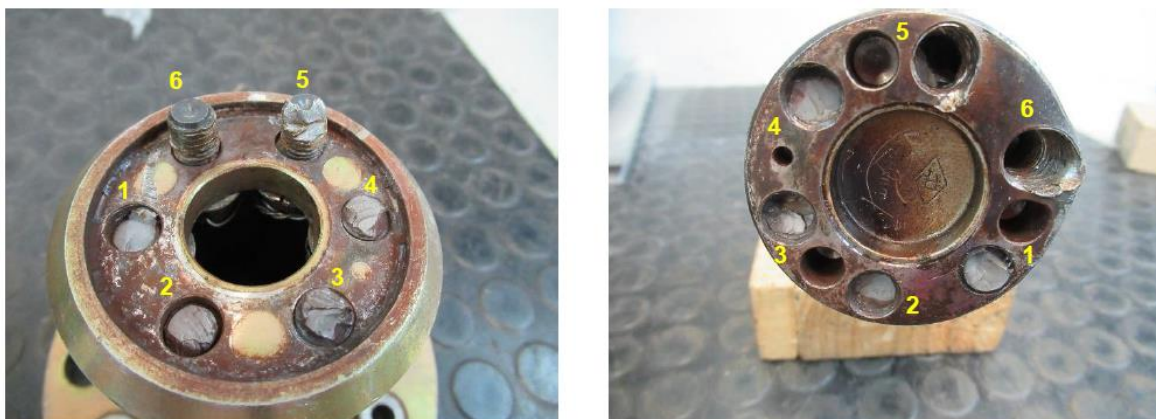
Ilustración 6: Unión de cigüeñal al plato de la hélice con la numeración de los tornillos fracturados
