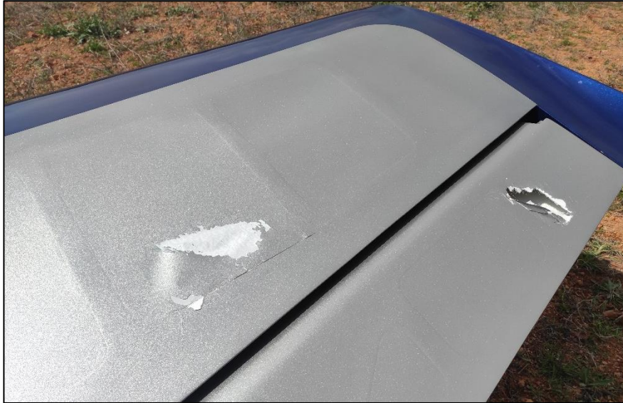
Ilustración 4: Daños en el extradós del plano derecho
