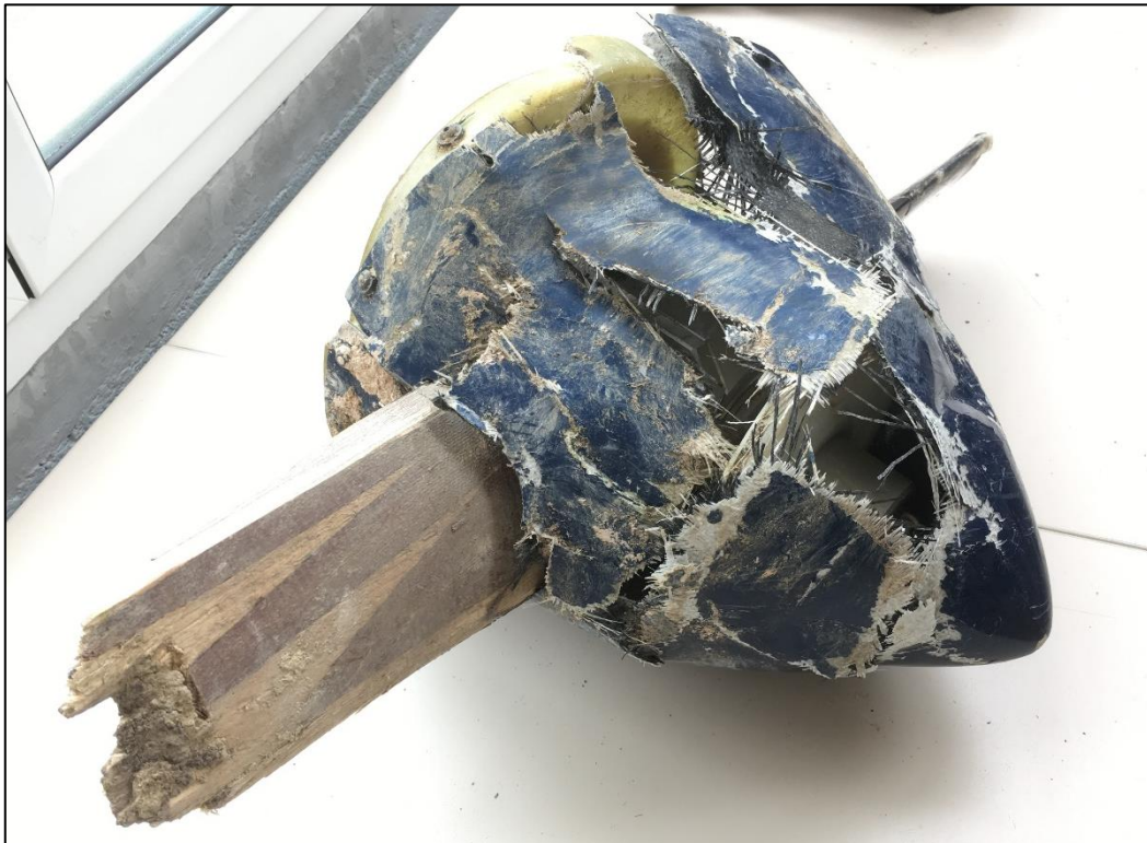
Ilustración 5: Hélice desprendida en vuelo
