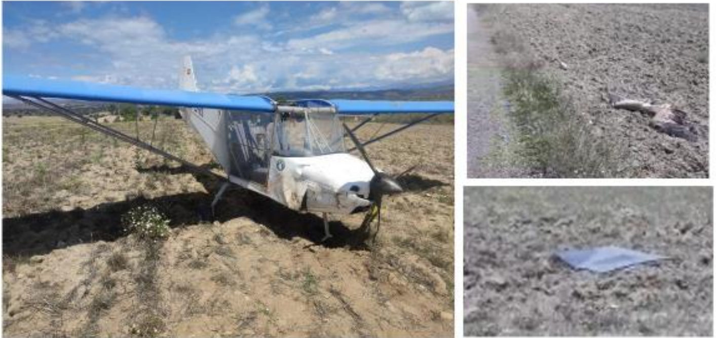
Figura 3 Posición final de la aeronave, del buitre y del techo
