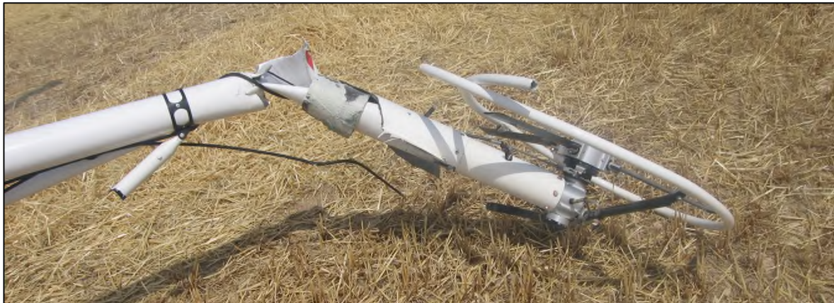
Ilustración 9: Daños en mástil de cola y rotor antipar
