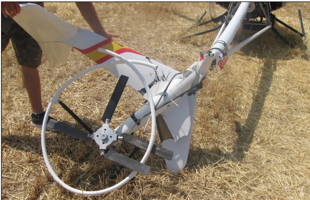
Ilustración 11: Daños en 'Shark Fin' y el rotor antipar
