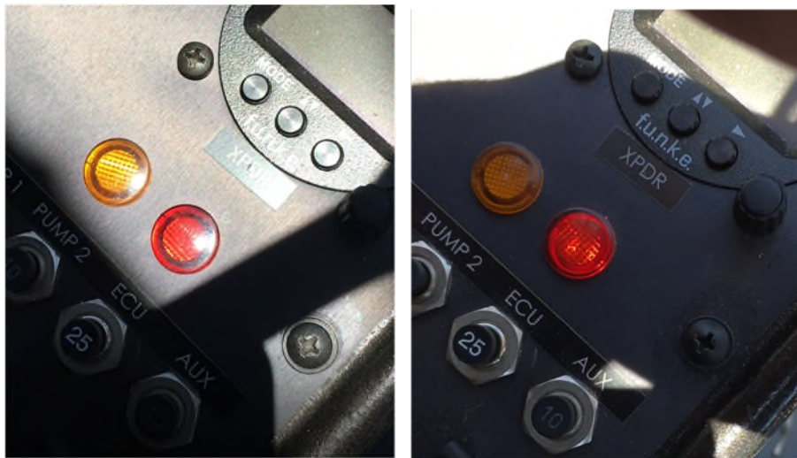
Ilustración 4: incidencia del sol en alarma de baja batería (entre otros avisos)
