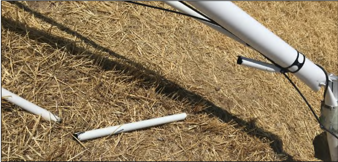
Ilustración 10: Rotura de riostra izquierda
