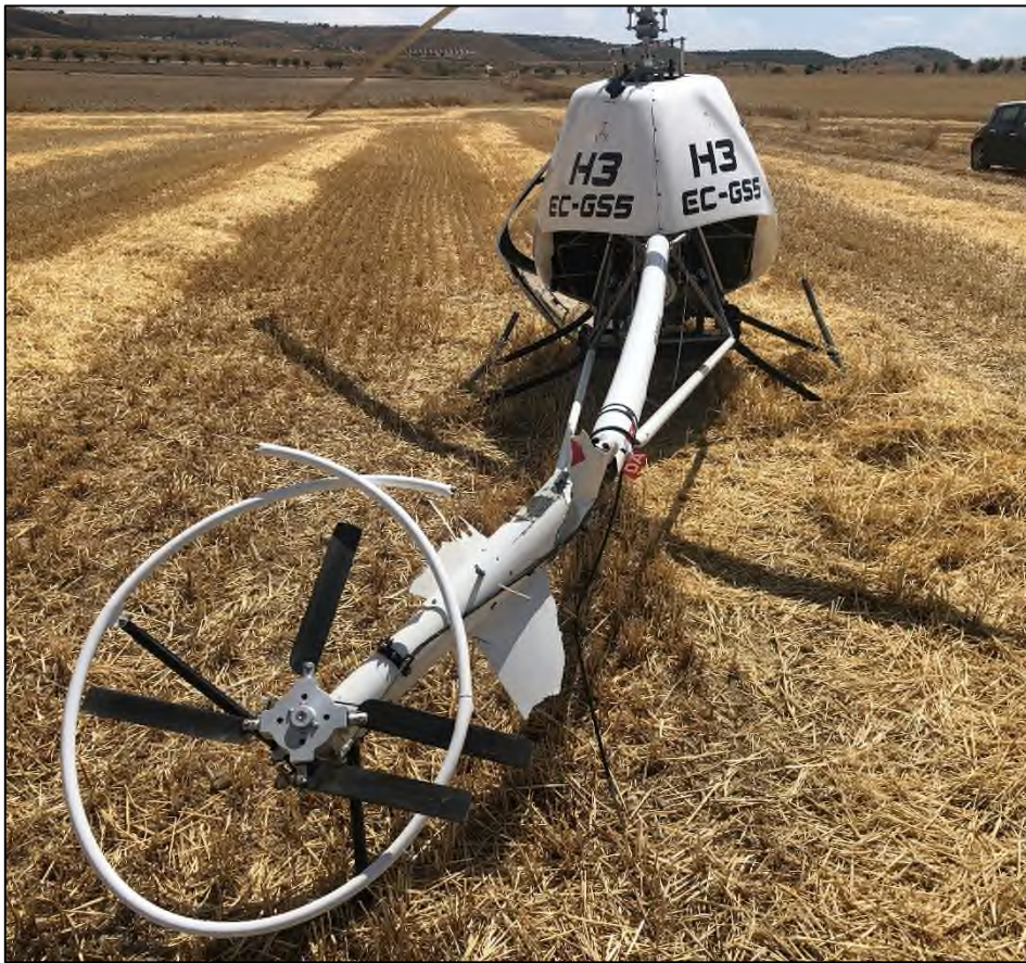
Ilustración 13: Daños en la cola, rigidizadores del mástil y en los patines.
