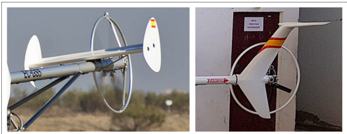
Ilustración 2: Diseños anteriores de los estabilizadores vertical y horizontal
