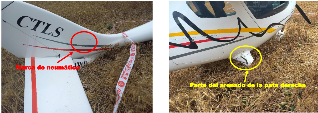
Figura 5 Daños en la pata y marca de la rueda en el carenado
