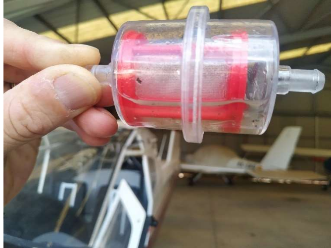
Ilustración 9 Agua presente en el filtro de combustible
