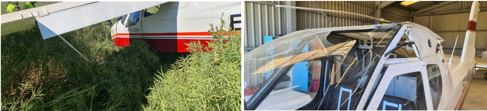
Ilustración 6 Estado final de la riostra y parabrisas
