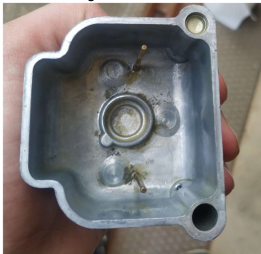
Ilustración 8 Marcas de óxido en cubetas del carburador
