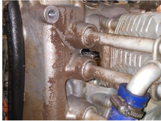
Figura 8: Detalle rotura cárter (2).
