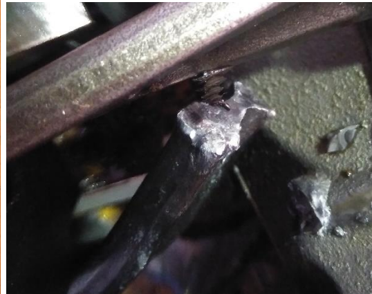
Figura 11: Detalle rotura de la biela (lado de cuerpo).
