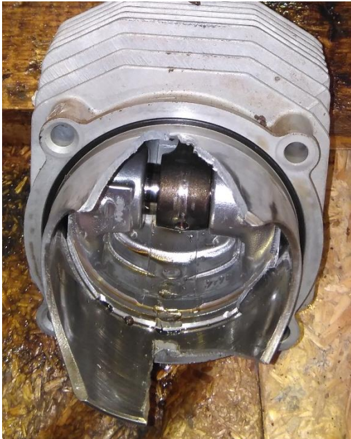
Figura 15: Detalle rotura de la camisa del cilindro y del pistón #2.
