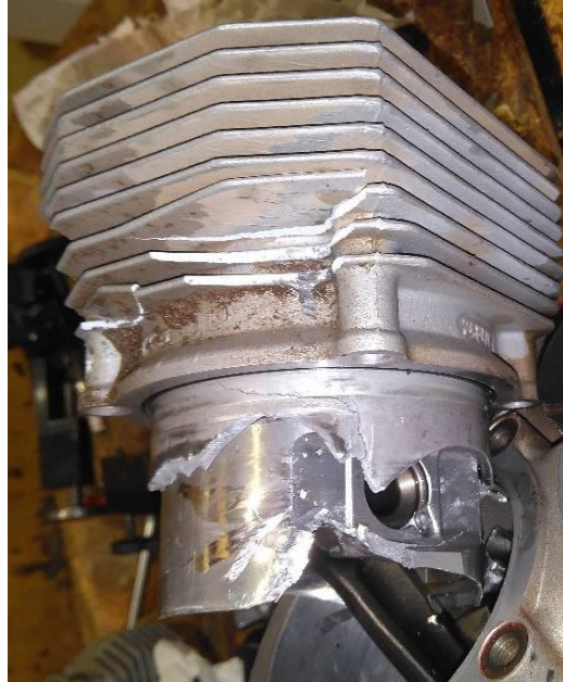
Figura 16: Detalle rotura de la camisa del cilindro y del pistón #1.
